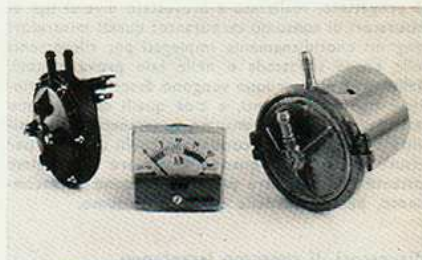
Fig. 4 - Prototipi di trasduttori per misuratori di consumo istantaneo in versione commerciale. Al centro uno strumento indicatore.
